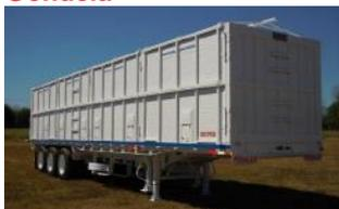
Vehículo no motorizado que es remolcado por un cabezal o camión chasis para el transporte de carga. Consiste en una caja de metal o madera, de forma rectangular, descubierta en su parte superior y de planos laterales de altura reducida. Son de muy variadas dimensiones, según su uso y propósitos.
