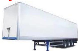
Vehículo no motorizado, generalmente remolcado por un vehículo automotor, en forma de caja rectangular de dimensiones muy variadas, totalmente cerrado, con puertas de acceso en la parte posterior. También denominado contenedor, generalmente es remolcado por un camión tráiler o camión chasis.
