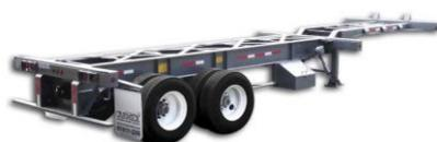
Vehículo no motorizado que se engancha a los cabezales para transportar contenedores.
