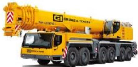
Vehículo de más de 4 ejes, que incorpora una grúa en su chasis, para cargar y descargar objetos pesados, o bien para desplazarlos dentro del radio de acción del “brazo” o “pluma” de la grúa.
