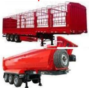
Vehículo no motorizado, de mayores dimensiones que los remolques, exclusivos ser remolcados por camiones y cabezales. Pueden ser contenedores simples o insolados, giratorios para volteo y otros propósitos.
